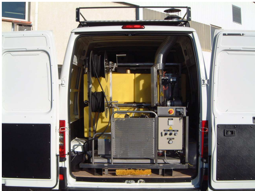
Modèle avec réservoir d'eau 2x500 litres – moteur refroidissement liquide Lombardini
